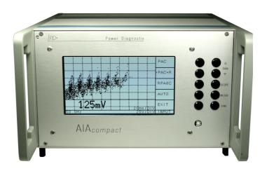
L'AIA compact est un appareil portable destiné aux mesures et à la localisation des décharges partielles sur des équipements électriques en service, comme par exemple des postes blindés (GIS), transformateurs et accessoires de câbles. Il est conçu pour s'adapter à de nombreux accessoires, capteurs acoustiques piézo-électriques et autres, ainsi que pour effectuer des mesures de DP avec des capteurs UHF pré installés.
