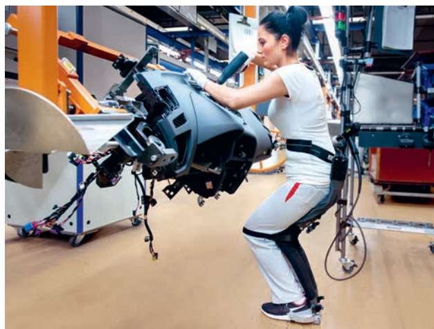
Der Chairless Chair erleichtert viele Tätigkeiten in der Montage. Diese High-tech-Konstruktion aus Carbon ermöglicht den Audi-Mitarbeitern das Sitzen ganz ohne Stuhl. Zugleich sorgt sie für eine verbesserte Körperhaltung und reduziert die Beinbelastung.
