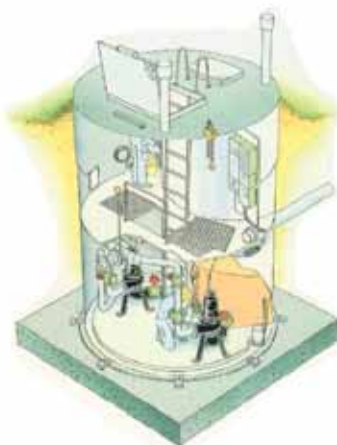
Комплектная насосная станция с отдельной приемной камерой
