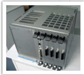
H&P ADVANCED TECHNOLOGY 10 Gerador de alta tensão pulsada (3kV, 100mA)
