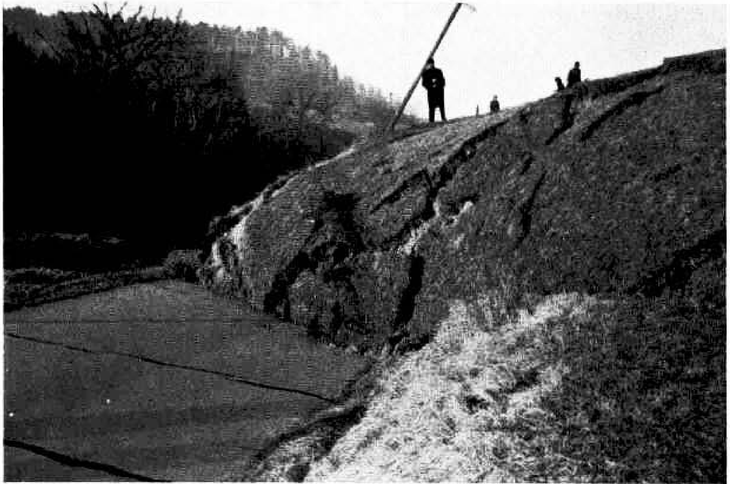
Abb. 8 Ein Wulst hat sich über die Straße geschoben. Die nächst untere Scholle dreht sich infolge Belastung.
