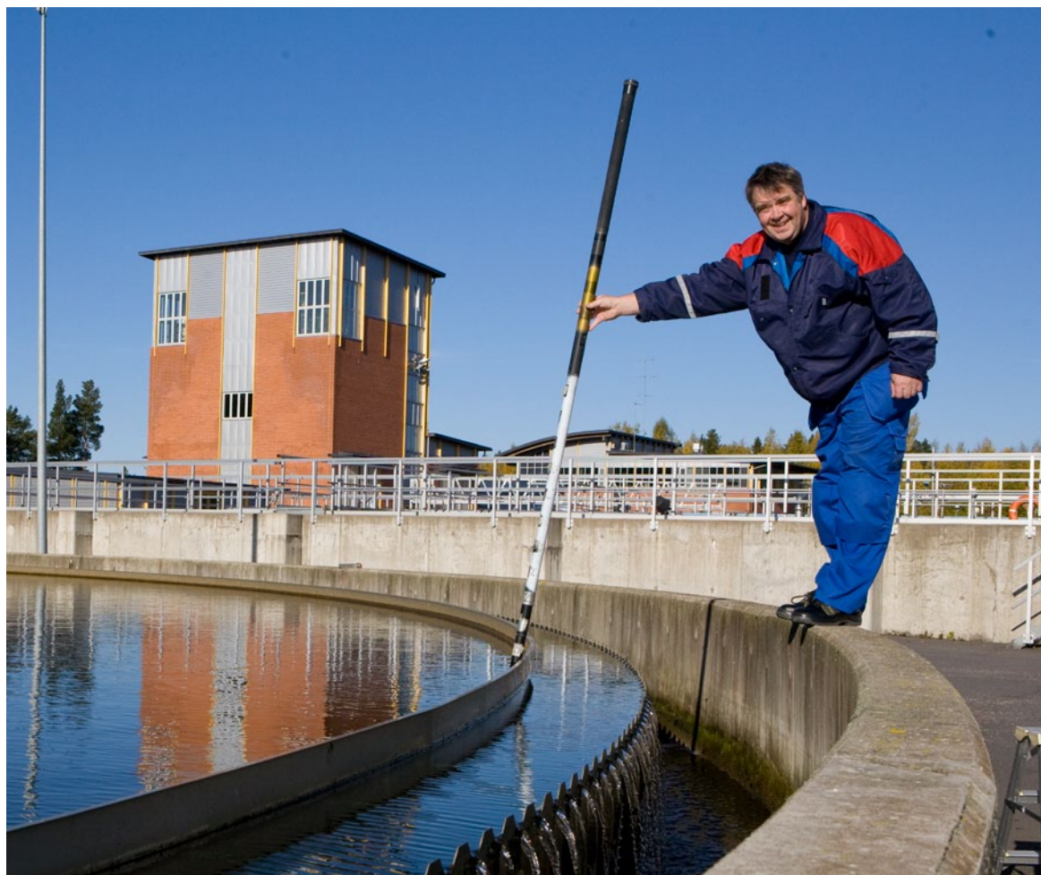
Näkösyydyden mittausta lähtevän veden altaassa, laitospäivä Sune Broman työssä. Processman Sune Broman mäter siktdjupet i bassängen för utgående vatten.
