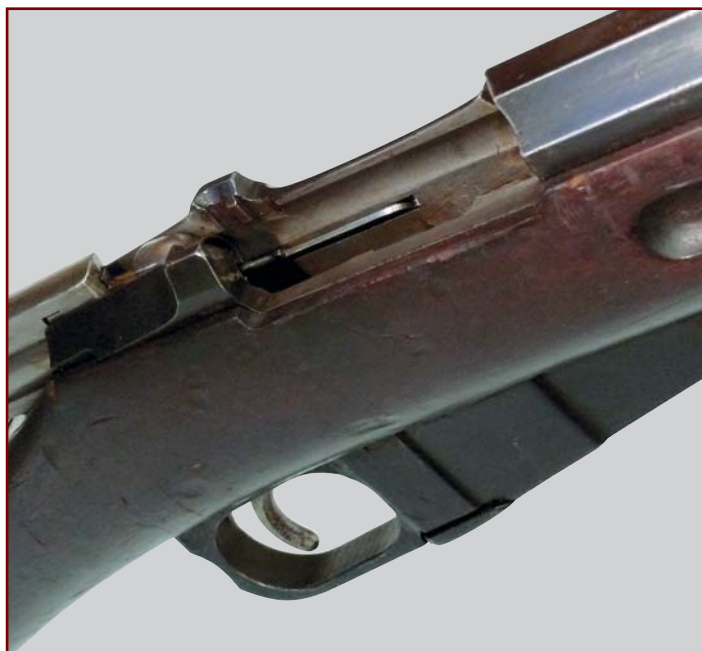
Разница в конструктивном исполнении отсечки патронов нагановской и мосинской систем видна невооружённым взглядом
