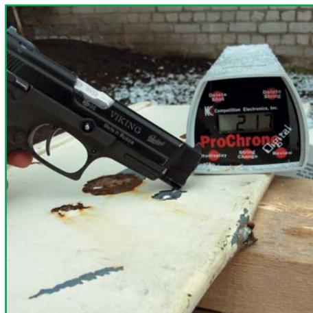
1-мм сталь и 50-мм доски снизили скорость пули до 217 м/с
