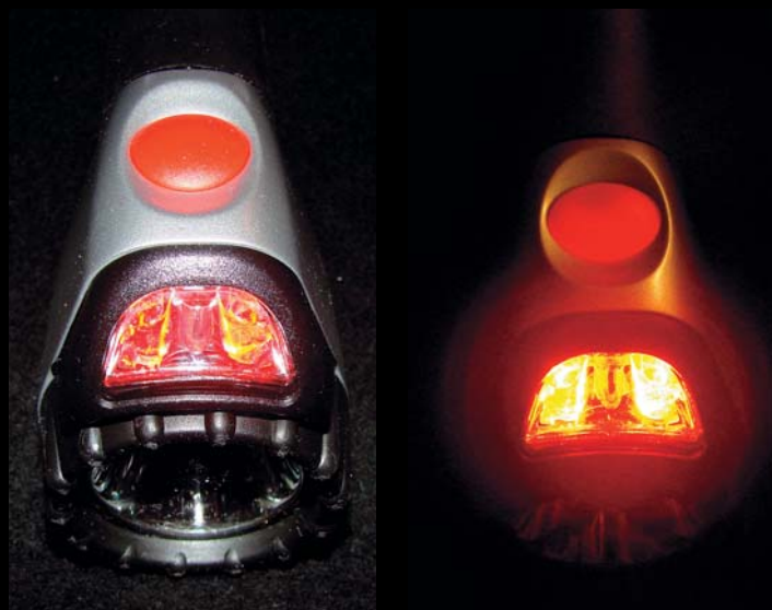
Диодное табло «Варты» имеет два диода красного спектра. Белый диод обеспечивает «ближний курсовой свет». Рефлектор лампы снизу
