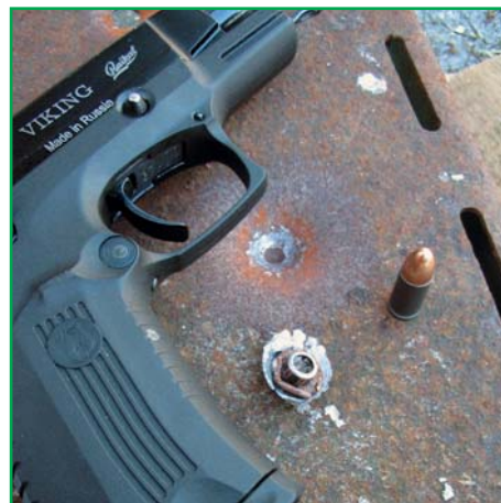
Пробить 2-мм сталь патроном ТПЗ так и не удалось!
