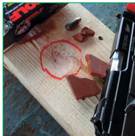
Маркером обведено место попадания пули в плитку. Только вмятина!
