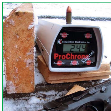
Скорость пули после пробития 50-мм доски составила 244 м/с. Патрон - барнаульский
