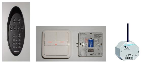
Different devices for KNX-RF (Siemens und Hager)
