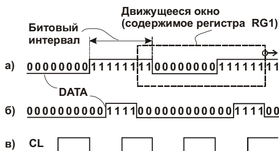
рис. 9.18. Временные диаграммы, поясняющие принцип действия коррелятора: a – сигнал DATA без искажений; б – сигнал DATA с искажениями; в – восстановленный синхросигнал
