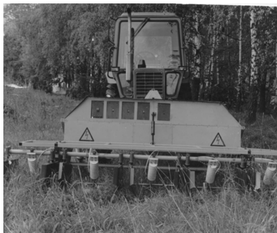
Рис. 9. Опытный образец высоковольтного электроимпульсного культиватора
