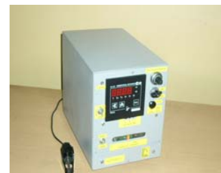
Устройство автоматического управления ЭТУ
