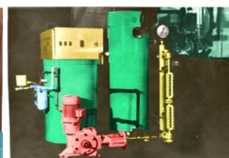
Электродный парогенератор ЭШГ-100, мощностью 100 кВт
