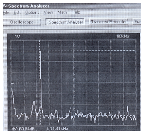
Рис. 7. Спектр тока в катушке накачки передающего трансформатора
