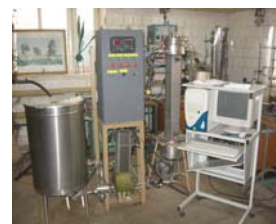
Инфракрасный пастеризатор молока и соков 1000 л/ч мощностью 12 кВт
