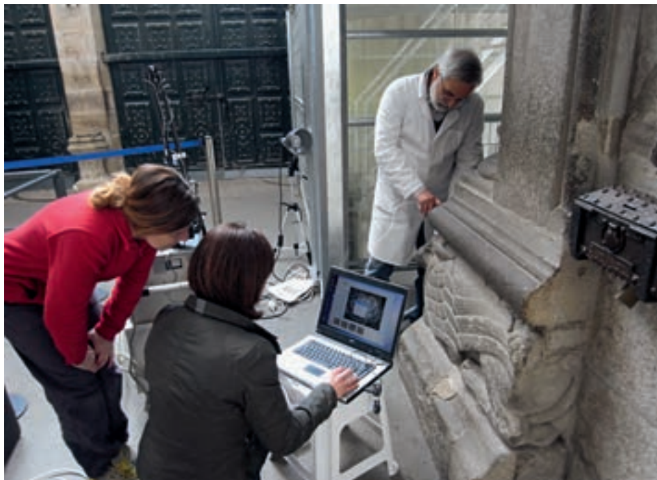
Figura 19. Evaluación de tratamientos de limpieza mediante videomicroscopía. Fotografía: Fundación Pedro Barrié de la Maza.
