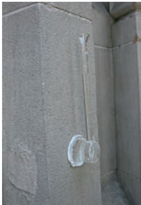
Figura 32. Evaluación in situ de la eficacia de un hidrofugante mediante el ensayo de la pipeta.
