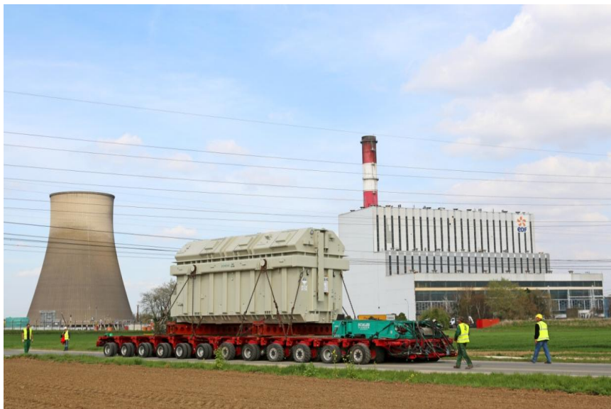
L'arrivée du convoi exceptionnel qui a transporté le transformateur électrique de la centrale, le 1 er avril 2014
