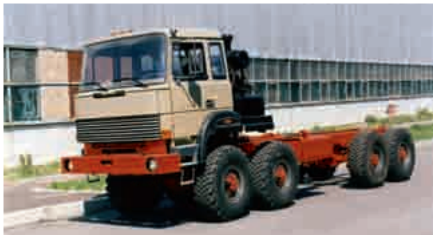
В начале 2000-х годов на площадях ООО «ИВЕКО-УРАЛАЗ» велась сборка четырехосных грузовиков «Урал-5323», которые комплектовались кабиной серии TurboTech
