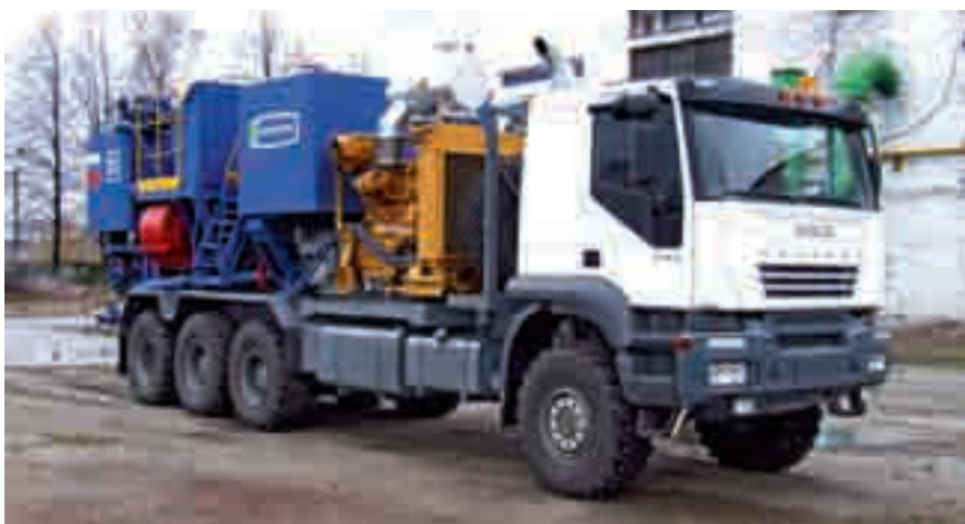
Разработанное конструкторами «ИВЕКО-УРАЛАЭ» уникальное шасси колесной формулы 8x6 с подъемной осью
