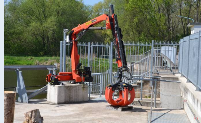
Hydraulik-Ladekran mit Sterngreifer, Foto: G. Ebel
