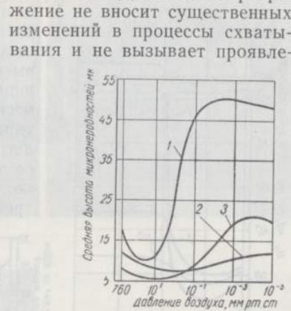
Рис. 61. Кривые зависимости средней высоты микронеровностей поверхности трения стали 45 от степени разрежения воздуха при нормальном давлении 10 дан/см² и скорости скольжения:
