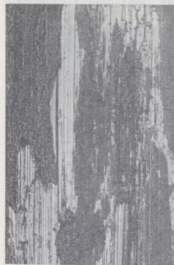
Рис. 16. Микрофотография поверхности трения образца из стали 45, подвергнувшегося испытанию в воздушной среде, (скорость скольжения 1,5 м/сек), \times 100 .
