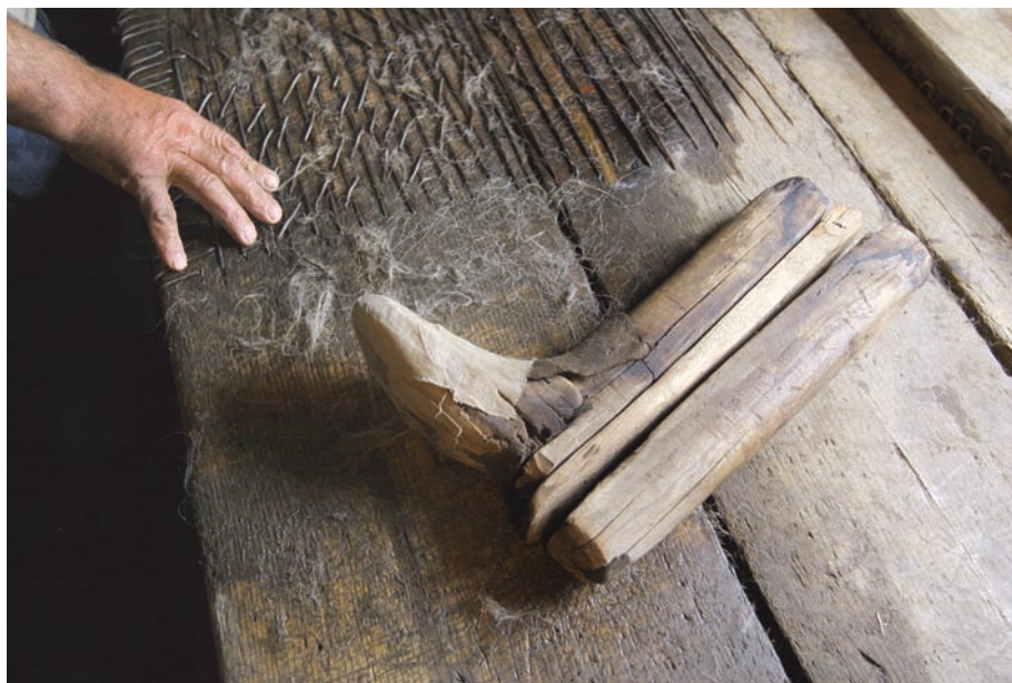
12. Колодка для изготовления валенок. В мастерской Н.В. Сысолятина.
