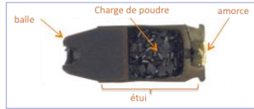
Figure 8 Coupe d'une cartouche de calibre 45 ACP (percussion centrale)
