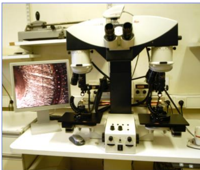
Figure 20 Macroscopie de comparaison LEICA ® FSC. Grossissement de x10 à x120 – Eclairages frisans, coaxiaux et annulaires
