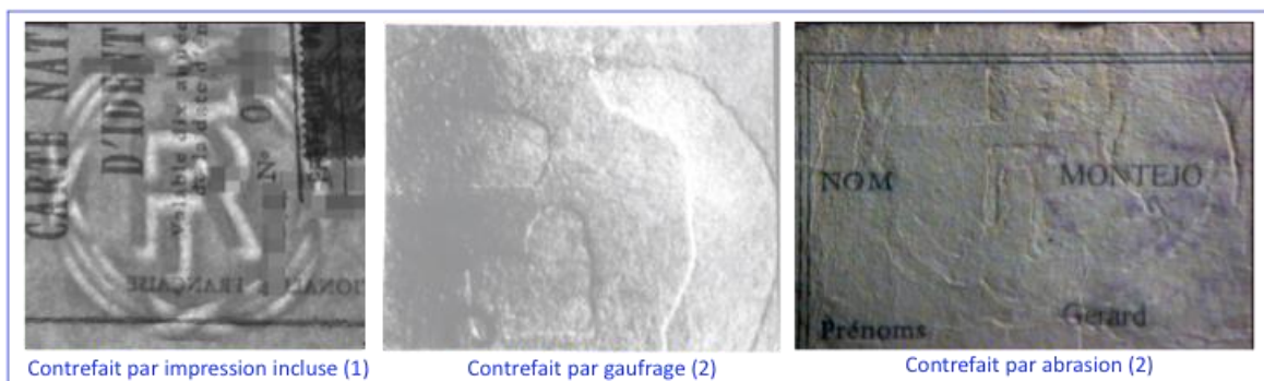
Figure 16 Faux filigranes : L'observation sous grossissement, en lumières transmise (1) et en lumière rasante (2), permet de déceler les faux filigranes et déterminer leur mode de fabrication.
