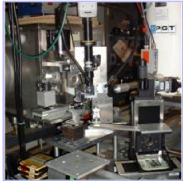
Figure 5 : analyse par fluorescence X : synchrotron du LURE à Orsay Ligne 15 en 2002 ayant servi à mesurer l'As sur les cheveux de Napoléon 1 er [31]
