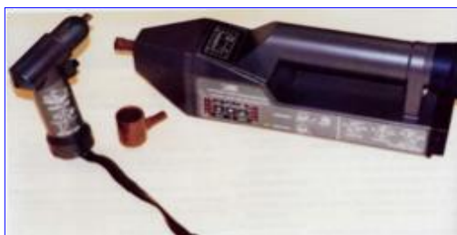
Figure 7 Détecteur de contrôle AP2C avec le dispositif S4 PE adapté aux liquides Pour gaz neurotoxiques GA, GB, GD, GF, Vx et moutarde (HD)
