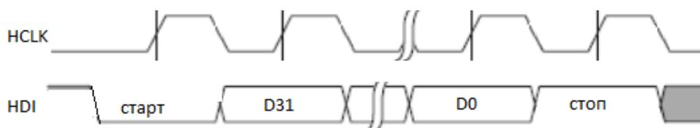
**Рисунок 31 – Прием информации контроллером интерфейса**
