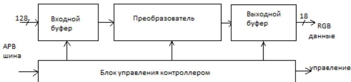
Рисунок 53 – Структура контроллера
