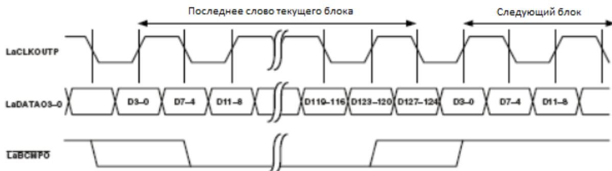
Рисунок 44 – Порт связи “а” передает порту связи “b” с завершением блока (новый блок из порта связи “а” следует немедленно после завершения первого блока)
