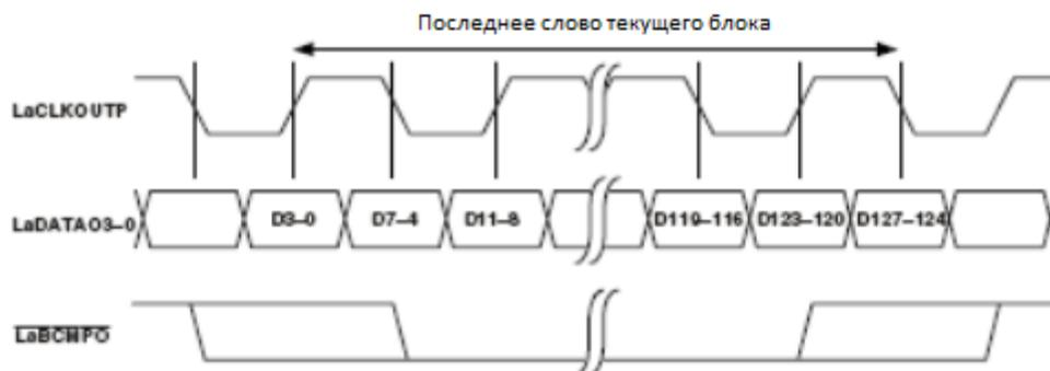
Рисунок 43 – Порт связи “а” передает порту связи “b” с завершением блока
