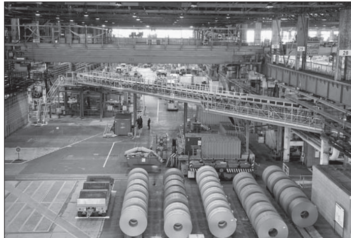
Kopplung: Bandbrücke in der Halle 3
