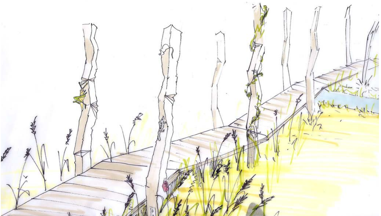
Abb. 98. Holzstege sollen punktuell eingesetzt werden, um feuchte Stellen zu überwinden und an besondere Gewässersysteme heranzuführen. An den Stützen können Informationselemente in Form von geschnitzten Tierchen angebracht werden. Die Zugänge von dem bestehenden Wegesystem aus werden in Form wassergebundener Wegedecken ausgebildet.
