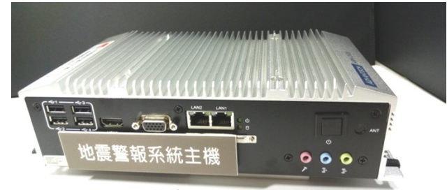
地震警報系統主機正面照
