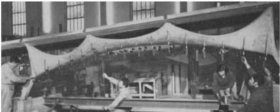
Fig. 7 – Il modello in microcemento allestito presso i laboratori dell'ISMES di Bergamo
