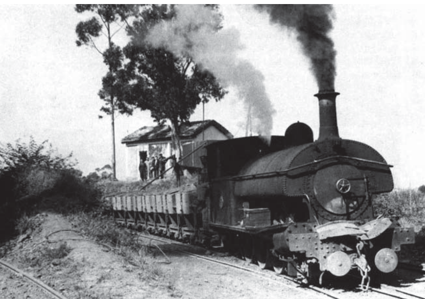
Locomotora nº 15 de Beyer Peacock 1-3-0T 2.903/1887
