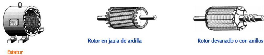
Figura 1 Clasificación de las máquinas de inducción según el tipo de rotor
