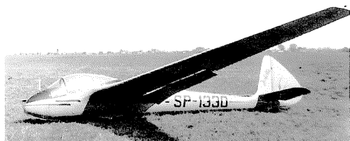
SZD-8 bis Jaskółka bis z wychylonymi klapami
