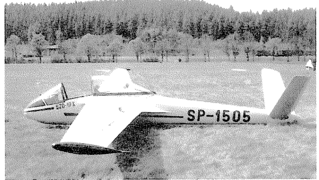
SZD-17X Jaskółka L o laminarnym profilu skrzydła, zbudowana w 4 egzemplarzach
