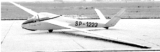
Szybowiec doświadczalny SZD-14X Jaskółka M z usterzeniem motylkowym, przerobiony z drugiego prototypu
