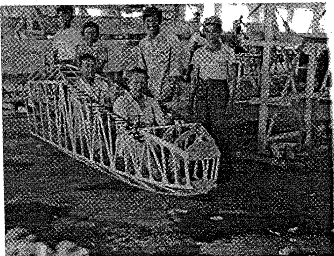
Kadłub szybowca Jie-fang 1 w budowie
