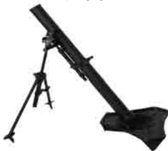
Aruncătorul de bombe, calibrul 82 mm, model 1977
