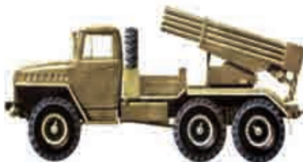
Aruncătorul de Proiectile Reactive BM-21 „GRAD”, calibrul 122 mm
