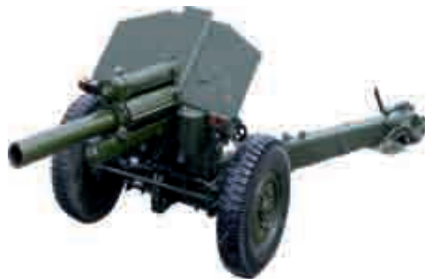
Obuzierul M-30, calibrul 122 mm, model 1938 - modernizat
