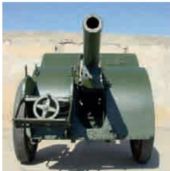
Obuzier „Skoda” cal. 100 mm, model 1930, monofleș. Roțile originale erau de lemn dar prin modernizare au fost înlocuite cu cele ale obuzierului cal. 122 mm, model 1938
