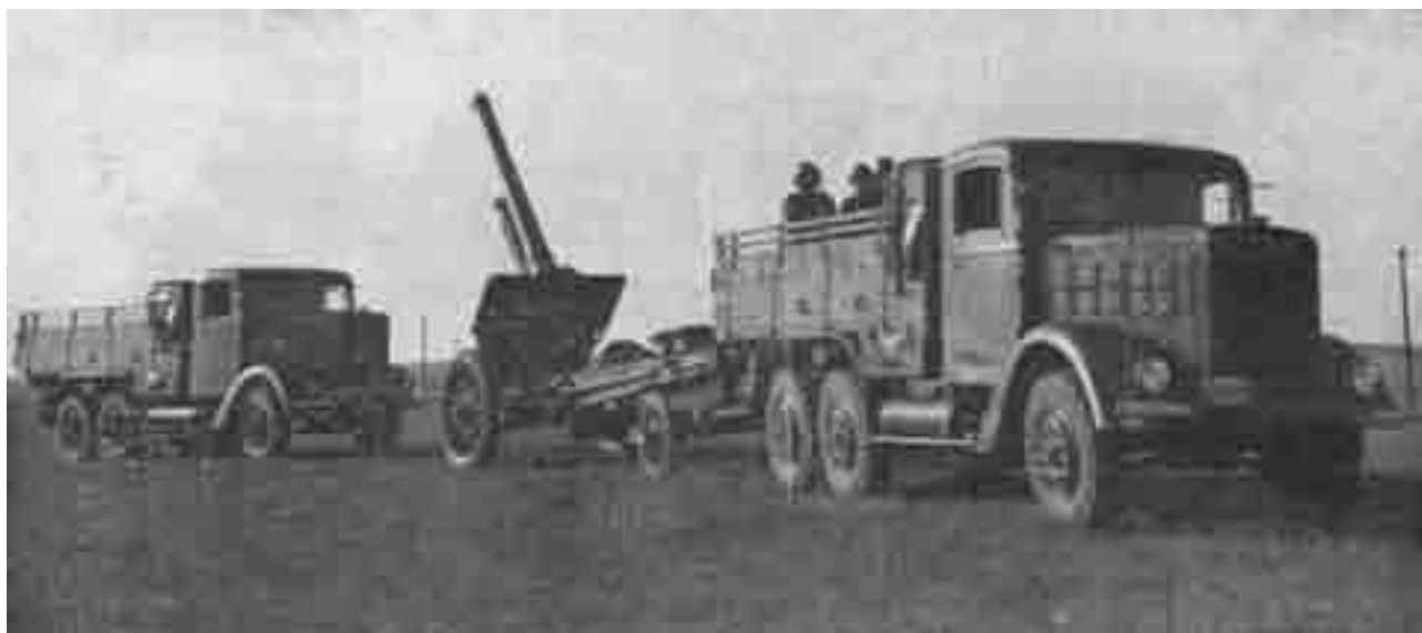
Obuzier „Skoda” cal. 150 mm, md. 1934 tractat cu autovehicul „Skoda” md. 6 ST 6T
