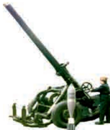
Aruncătorul M-240, calibrul 240mm, model 1950
