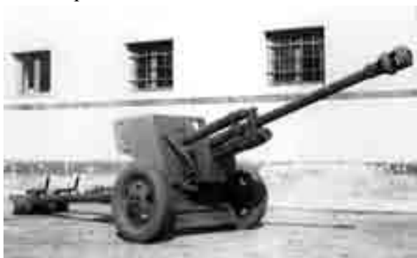
Tunul antitanc „REȘIȚA DT-UDR Nr. 26, calibrul 75 mm, model 1943
