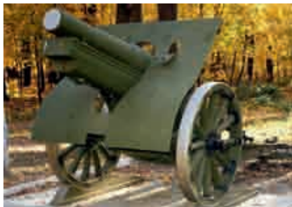
Obuzierul „SCHNEIDER-PUTILOV”, calibrul 152 mm, model 1910
