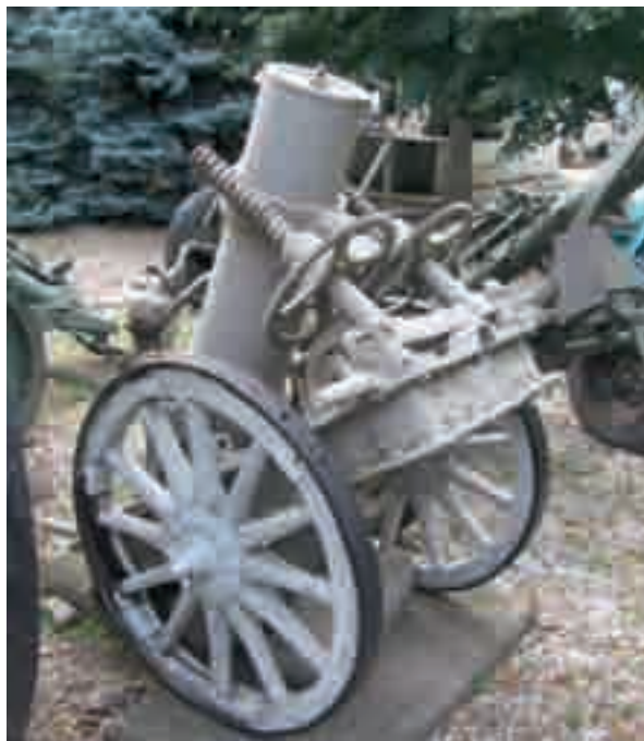
Aruncătorul greu „Böhler”, calibrul 225 mm
