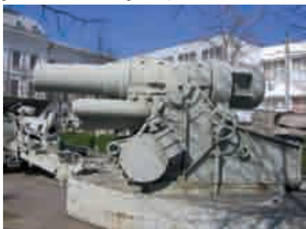
Mortier „Skoda”, calibrul 305 mm, model 1916. Afetul piesei este mai modern. Se observă diferențe constructive, în special prin dispunerea legăturii elastice sub țeavă (M.M.N.)
