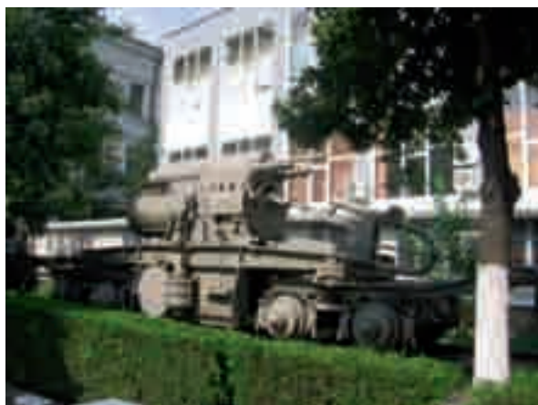
Afetul cu legătura elastică și dispozitivul de încărcare ale obuzierului „Skoda”, calibrul 380 mm, model 1916, așezate pe 2 osii duble de cale ferată. Este cea de-a doua componentă a obuzierului
