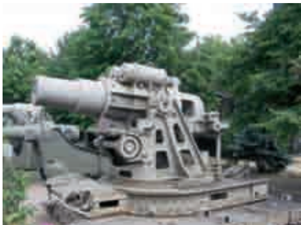
Mortier „Skoda”, calibrul 305 mm, model 1911/16. Afetul piesei este așezat pe un postament metalic (M.M.N.)
