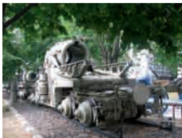
Afetul obuzierului de 420 mm, model 1916 dispus pe platforma de cale ferată
