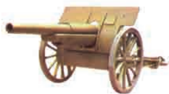
Tunul „SCHNEIDER-PUTILOV”, calibrul 107 mm, model 1913/1917
