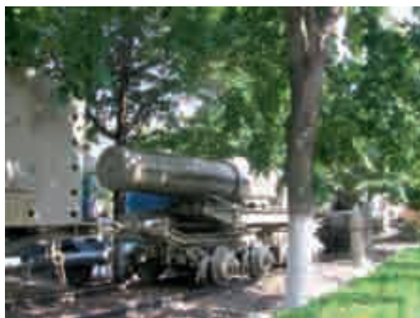
Platforma care transportă țeava obuzierului de calibrul 420 mm
