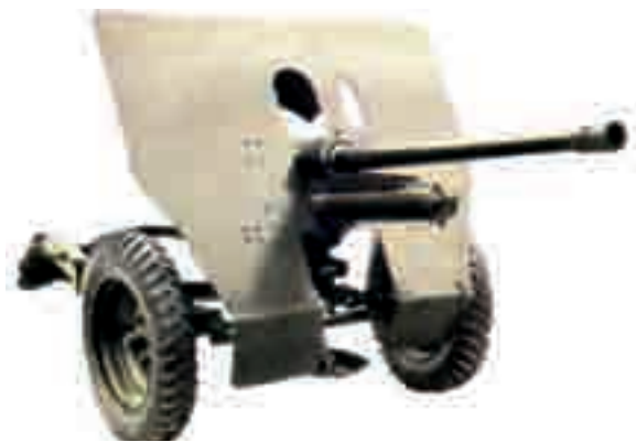
Tunul antitanc „BÖHLER”, calibrul 47 mm, model 1935
