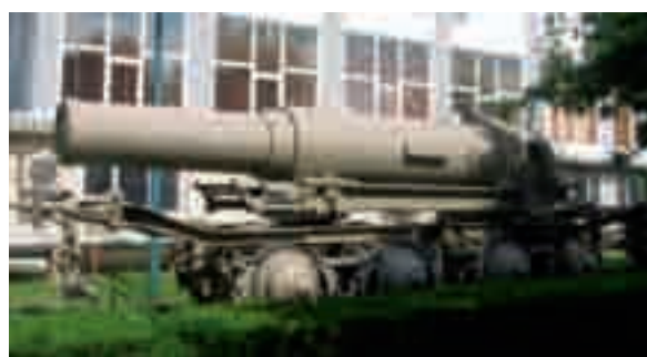
Țeava cu lungimea de 6,46 m a obuzierului „Skoda”, calibrul 380 mm, cu denumirea „Gudrun” (M.M.N.)
