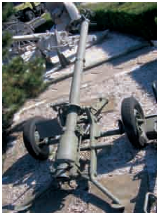
Tunul fără recul B-11 (RG107), calibrul 107 mm, model 1954
