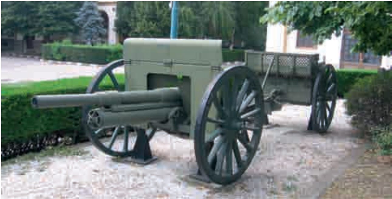
Tun „Putilov” cal. 75 mm, md. 1902/1936 modernizat prin tubare amovibilă (Piesă din colecția Muzeului Militar Național)
