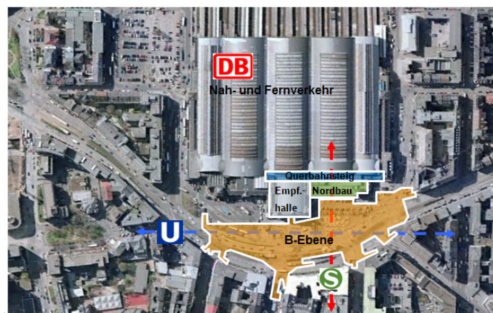
Abbildung 92: Frankfurt/Main B-Ebene - Projektbestandteile; Quelle: I.SBH
