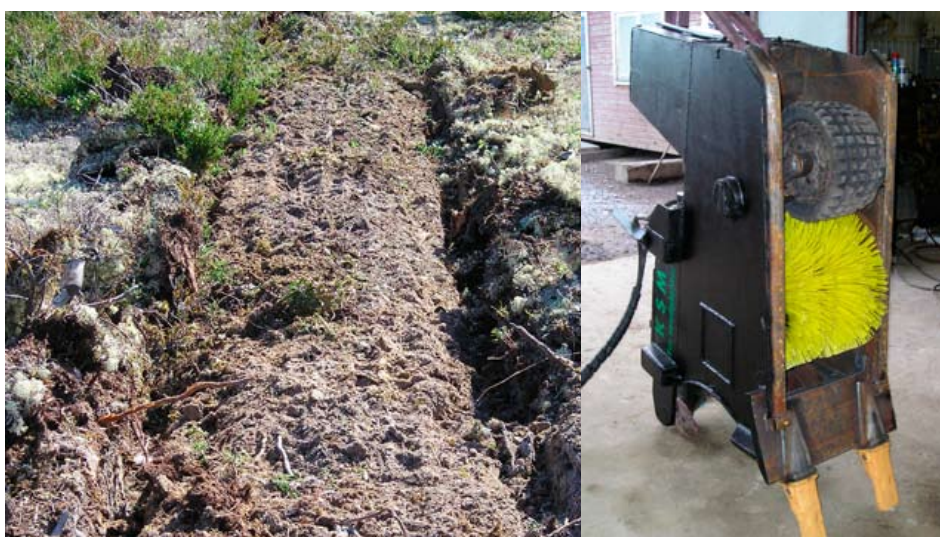
Figur NF29 Exempel på ett aggregat – ”Eco seedplanter” – med skonsam markberedningsteknik för torra marker. Markberedningen skapas i detta fall med en roterande plastborste. Aggregatet på fotot är även försett med ett mikroprepareringshjul och såddmatning. Foto Bror Österman.
