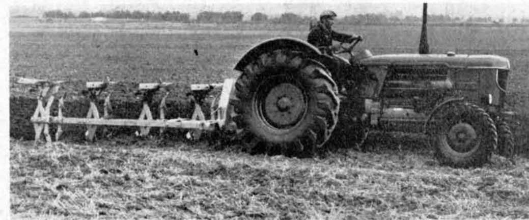
Der neue 75-PS-Trecker von Klöckner-Humboldt-Deutz mit luftgekühltem Sechszylindermotor, mit einem vierscharigen Drehpflug, bei der Arbeit.
