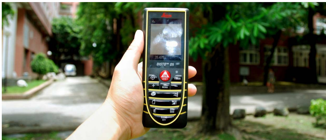
圖 3-4 手持式雷射測距儀。
