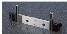
Uchwyt B i C : Służą do połączenia dwóch długich płytek wzorcowych razem z innymi płytkami wzorcowymi do 35 mm (Uchwyt B) lub 140 mm (Uchwyt C). Wykorzystywane również do mocowania szczęk za pomocą dwóch adapterów. Uchwyt B : 619032 (R maks.= 90 mm- L= 126 mm) Uchwyt C : 619033 (R maks.= 200 mm- L= 236 mm)
