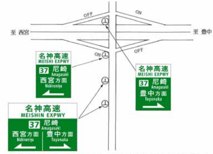
図4-9 ダイヤモンドインターチェンジにおける市街地案内標識(参考図)
