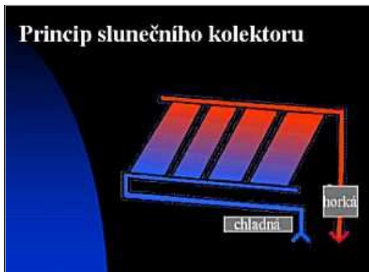
Obr. 13: Nejčastějším zařízením na využití sluneční energie je sluneční kolektor
