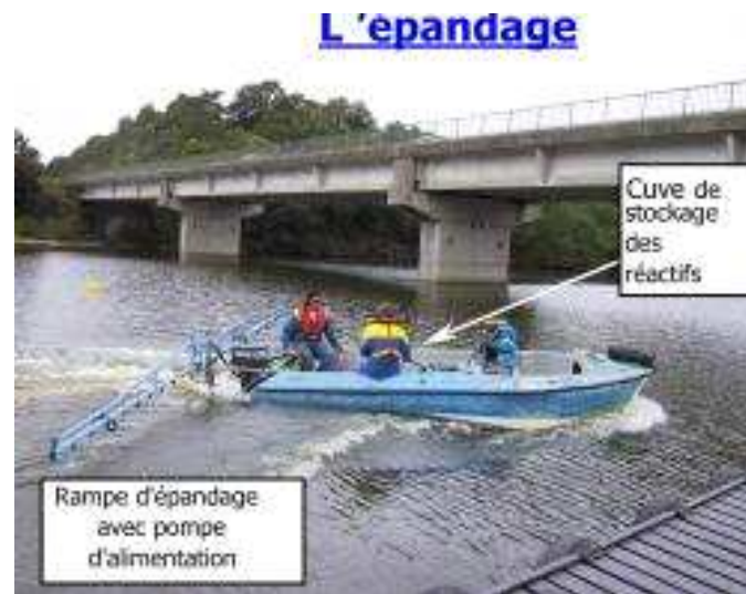
Embarcation permettant d'épandre en surface du plan d'eau la solution de cuivre
