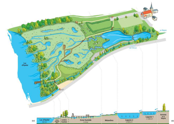
Schéma du système de pré-barrage du lac d'Aydat
