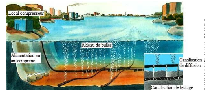
Système de circulation d'air dans un réseau à air comprimé
