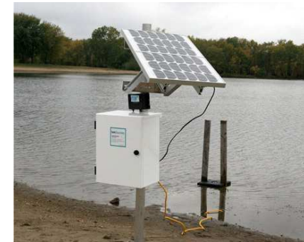
Système de panneaux solaires alimentant l'appareil à ultrasons
