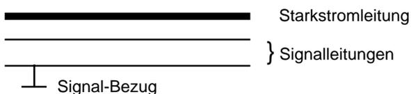
**Bild 1:** Induktive Einkopplung von Störspannungen
