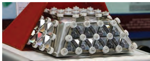
«Интеркосмос-22 – Болгария-1300» на платформе «Метеор» и установленный на нём угловой отражатель для лазерной локации
