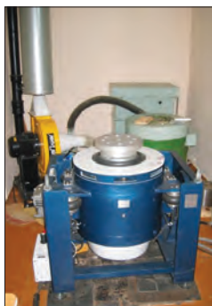
Новый вибростенд участка механических испытаний New vibrobench in the mechanical testing section
