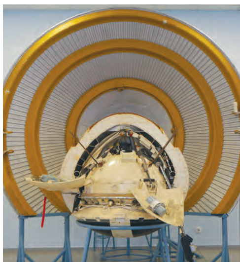
Спускаемый аппарат АМС «Марс-3» в музее НПО им. С.А. Лавочкина — посадочный аппарат в защитной оболочке и аэродинамический тормоз
