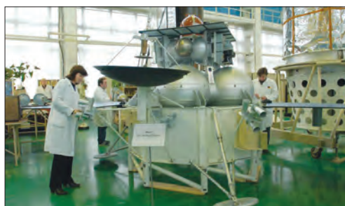
Технологический макет аппарата «Фобос-Грунт» в ИКИ на примерке комплекса научного оборудования
