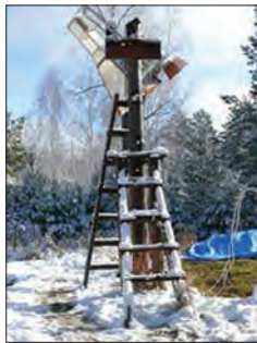
Радиометрический комплекс МИРК для изучения физических характеристик мёрзлых грунтов во время полевых испытаний. МИРК — комплекс из двух СВЧ-радиометров, работающих в диапазоне частот 2,7 и 6,9 ГГц с соответствующими антеннами. Использовался для измерений в КНЦ СО РАН
