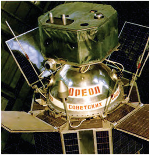
Спутник «Ореол» на платформе ДС-У3 советско-французского проекта АРКАД
