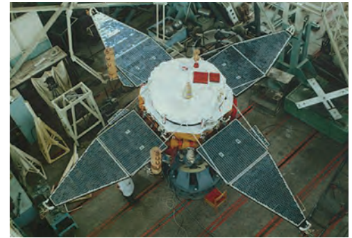
Сборка спутников «Интербол-1 и -2» в цехах НПО им. С. А. Лавочкина
