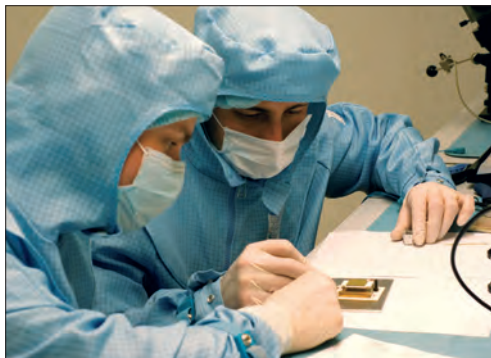
Сборка детектора рентгеновского излучения прибора МВН
