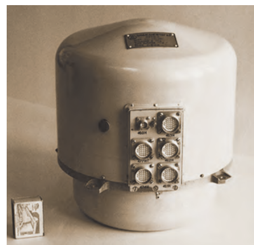
«Сигма-А» — первый отечественный хроматограф для исследования малых составляющих атмосферы Венеры («Венера-11 и -12»)
