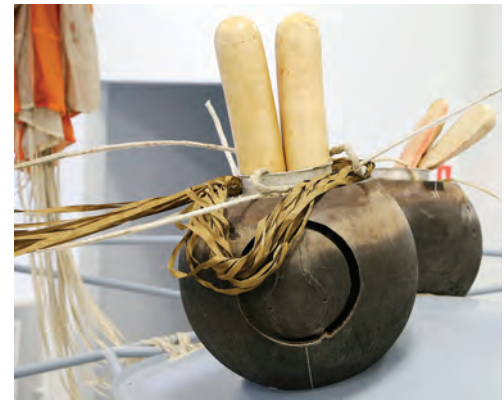
Подлинные капсулы АМС «Луна 16 и -24», доставившие на Землю лунный грунт, в музее НПО им. С. А. Лавочкина Genuine modules of Luna 16 and Luna-24, which returned lunar soil to the Earth, in Lavochkin Association museum
