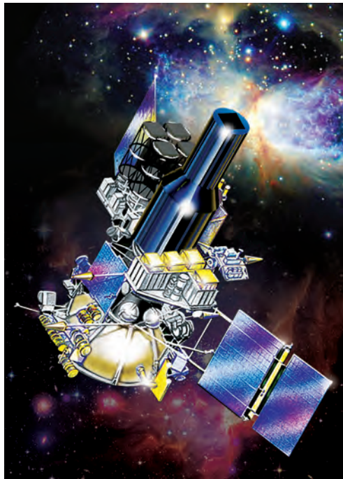
Обсерватория «Гранат». Основные инструмен- ты — АРТ-П и СИГМА — рентгеновские телескопы с кодирующими масками
