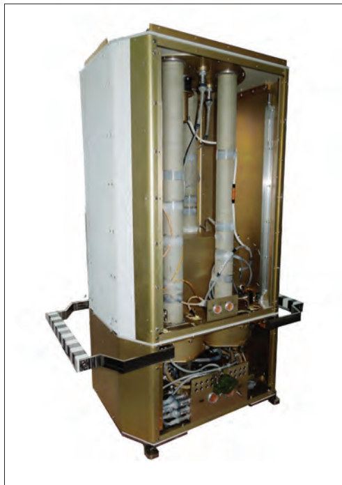
Устройство МВН. В зоне видимости следующие системы: в нижней части — блоки рентгеновских детекторов с блоком электроники; в средней — трехслойные цилиндрические коллиматоры и модуль управления приводами; в верхней части — система перекрытия апертуры
