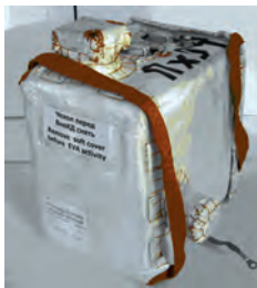
Блок БТН-МД в сборе с БТН-МФ с радиаторами закрытыми временными теплоизолирующими чехлами
