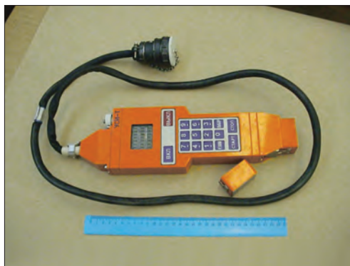
Бортовые комплексы СУСПД различных модификаций используются в составе аппаратуры привязных аэростатов различной высоты и назначения. Выполняют функции сбора и передачи данных о состоянии привязного аэростата, управления его агрегатами и полезной нагрузкой в автоматическом режиме и по командам с земли
