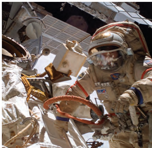
Американский астронавт Майкл Лопез-Алегрía во время установки детекторного блока БТН-МД на внешней поверхности служебного модуля «Звезда»
