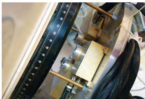
Испытания СДГ в САО РАН. Датчики гида на телескопе «Цейсс-1000»
