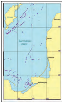
Результаты мониторинга нефтяного загрязнения Балтийского моря. Слева — сводная карта-схема нефтяных пятен в юго-восточной части Балтийского моря, выявленных в результате анализа данных спутниковой радиолокации в 2009–12 гг.; справа — распределение нефтяных пятен по различным районам
