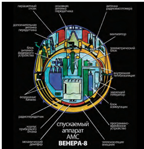
Схема устройства посадочного аппарата станций «Венера-7 и -8» Venera-7 and -8 lander's diagram
