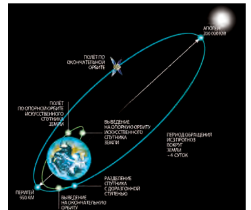
Построение типичной орбиты спутников «Прогноз»
