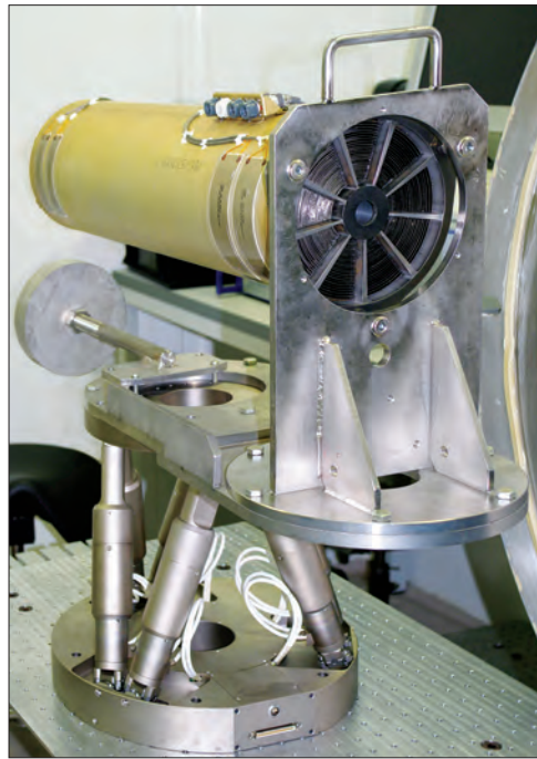
Рентгеновская зеркальная система с 28 оболочками, установленная на гексапode перед закаткой в вакуумную камеру для тестирования на квази-параллельном рентгеновском пучке
