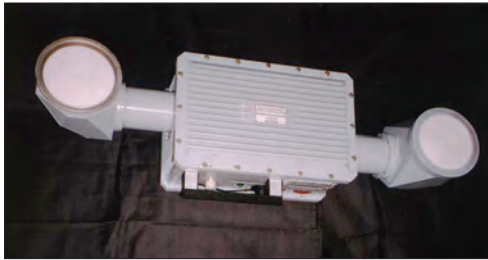
Когерентный радар для дистанционного зондирования снежных лавин в Альпах, разработанный и изготовленный по контракту с Институтом коммуникаций и распространения волн Технологического университета Граца (Австрия) (Technische Universität Graz)
