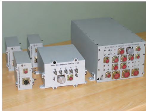
Бортовые комплексы СУСПД различных модификаций используются в составе аппаратуры привязных аэростатов различной высоты и назначения. Выполняют функции сбора и передачи данных о состоянии привязного аэростата, управления его агрегатами и полезной нагрузкой в автоматическом режиме и по командам с земли
