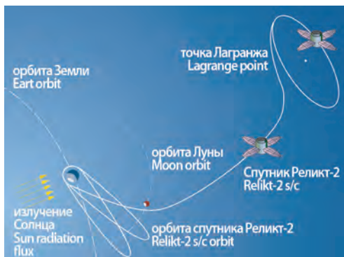
Схема гравитационного манёвра с использованием Луны для вывода в точку Лагранжа в не осуществлённом проекте РЕЛИКТ-2
