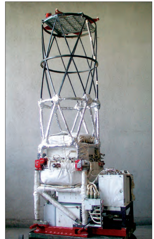
Один из модулей телескопа с кодирующей апертурой ART-P обсерватории «Гранат»
