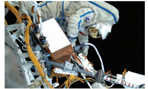
Установка волнового комплекса «Обстановка» на внешней поверхности МКС Obstanovka wave complex installation on the ISS
