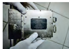
ДАН — детектор динамического альbedo нейтронов DAN — Detector of Dynamic Albedo of Neutrons
