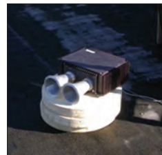
Аппаратура, созданная по темам «Оперетка» и «Бронепоезд» (государственный оборонный заказ). Целью работы было создание прибора «Обнаружитель», который состоял из пассивного канала — приёмник (слева), и активного — радиолокатор (посередине). Справа — лабораторные испытания прибора на крыше ИКИ РАН
