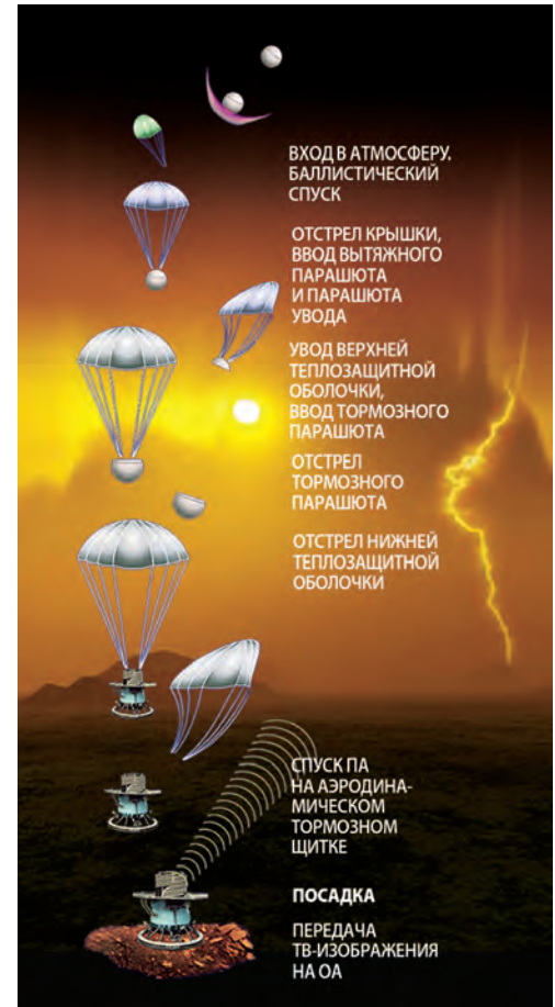
Схема посадки спускаемых аппаратов АМС «Венера-9, -10, -11, -12, -13, -14» на поверхность Венеры
