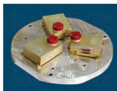
Три датчика гида на монтажной площадке. Технологический образец СДГ
