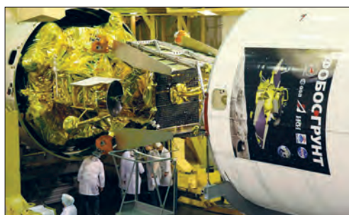
Накатка головного обтекателя на аппарат «Фобос-Грунт», пристыкованного к ракете-носителю «Зенит». Аппарат оснащён большим количеством приборов ИКИ РАН (картинка миссии на обтекателе создана в 31 отделе ИКИ РАН)
