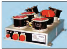
Прибор БМСВ в составе эксперимента по измерениям солнечного ветра «Плазма-Ф» на аппарате «Спектр-Р»
