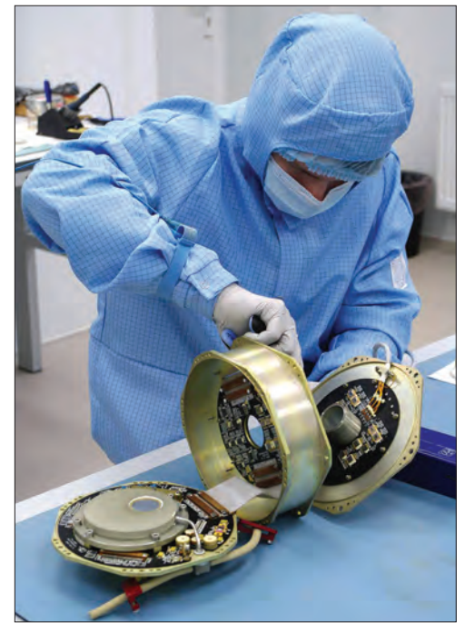
Сборка детектора телескопа АРТ-ХС ART-XC detector assembly
