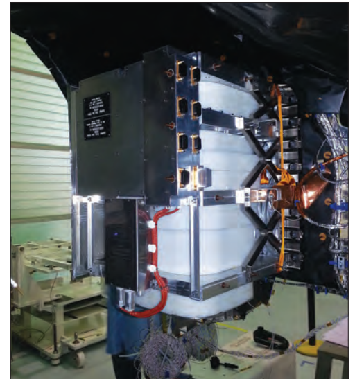
Общий вид лётного образца марсианского нейтронного телескопа ФРЕНД (вверху) и установка ФРЕНД лётного образца ФРЕНД на борту КА ЕКА ТГО (внизу) General configuration of a flight unit of the FREND neutron telescope (up) and general installation of the FREND flight unit on the ESA space vehicle TGO (down)
