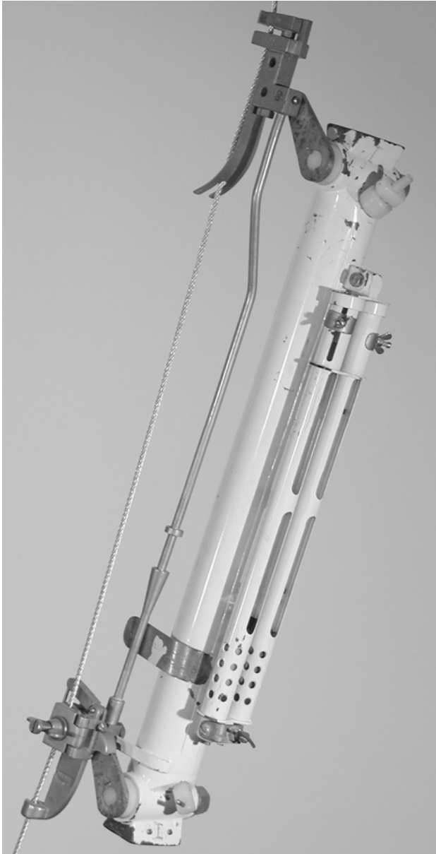
13. Nansens vannhenter i moderne utgave. Instrument 5 i monteringen
