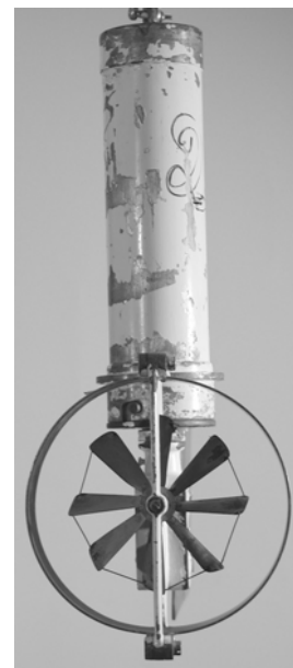
24. Sverdrup-Dahls elektriske strømmåler, konstruert om bord på "Maud" 1923. Se J.Opt.Soc.Amer. vol. 12, 1926 : Sverdrup & Dahl :Two ocean current recorders.
