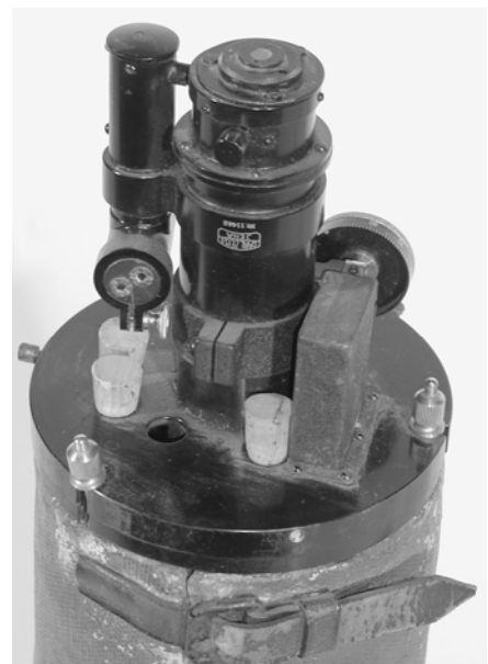
31. Interferometer for bestemmelse av saltholdighet. Sannsynligvis brukt på " Armauer Hansen" 1914. Se "The Eastern North Atlantic" (1926), s.9, eller "The waters of the North-eastern North Atlantic" 1913, s. 15.
