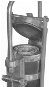
5. Isolert vannhenter med termometer inne i vannhenteren.
