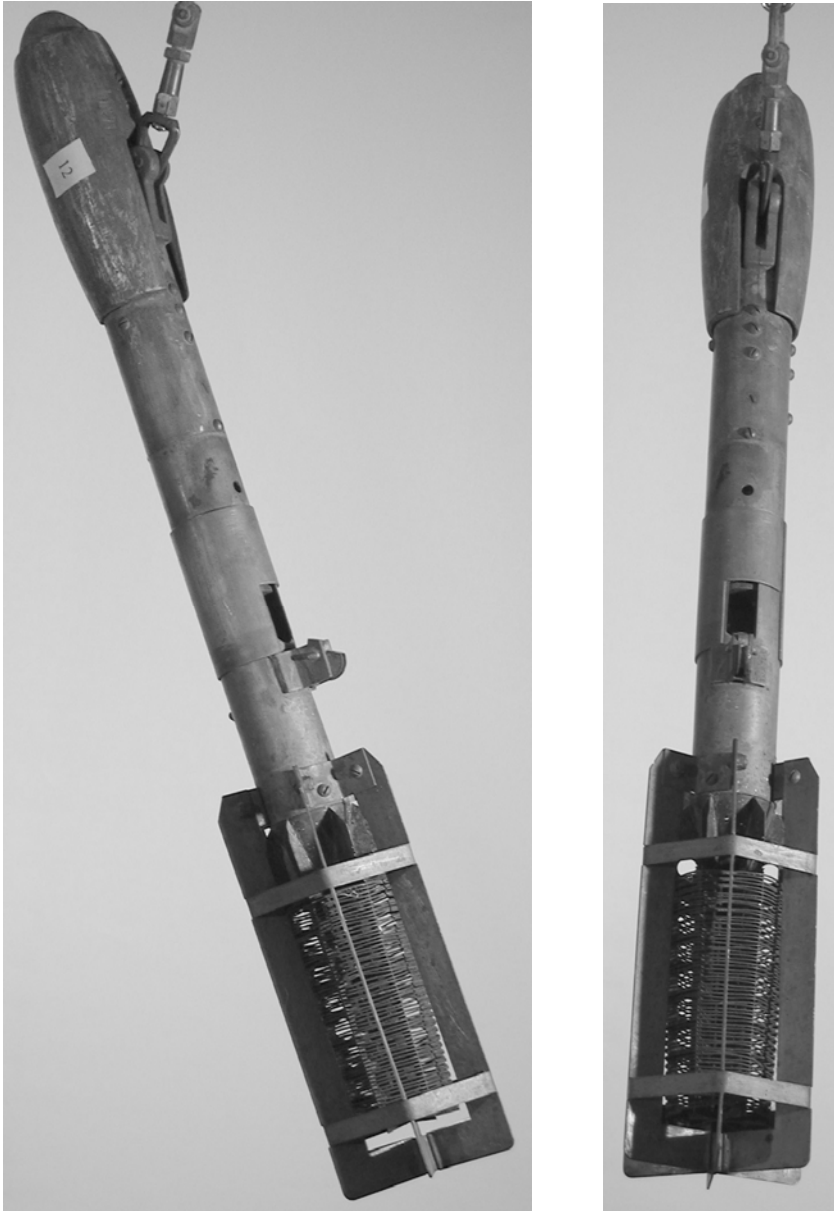
18. Spilhaus' bathythermograf. Se Spilhaus: "A bathythermograph" J.Mar. Res., 1938, s. 95. Tegner temperaturkurve på sotet glassplate.
