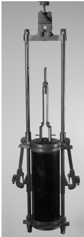
2. Pettersson-Nansen vannhenter, Denne er noe mindre enn nr.1. og har både såkalt dypvannstermometer og vendetermometer. Beskrevet av Ekman i PdC nr:23 (1905)
