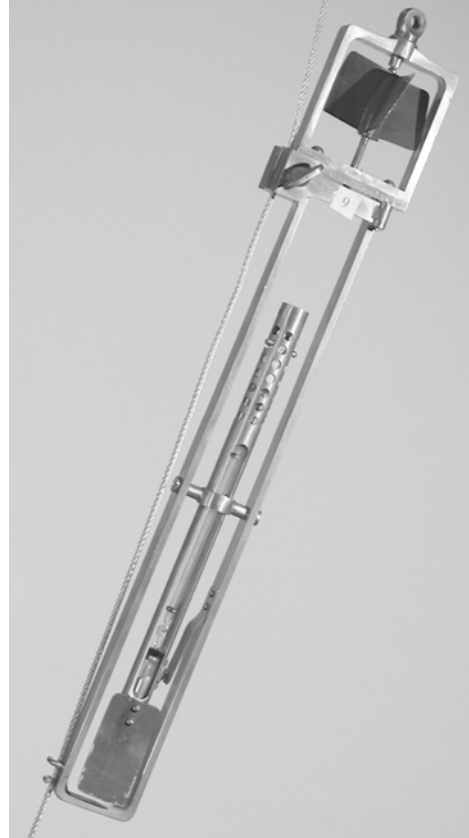
16. Venderamme for 1 termometer, med propellutløser. Se Helland-Hansen: "The Ocean Waters" 1912.
