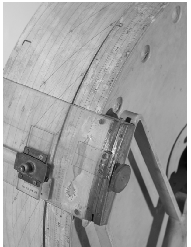
29. Regnehjul, konstruert ved Geofys. Inst. på grunnlag av Sunds regnestav . Se Univ. i Bergen, årsmelding 1951-52, s. 120.
