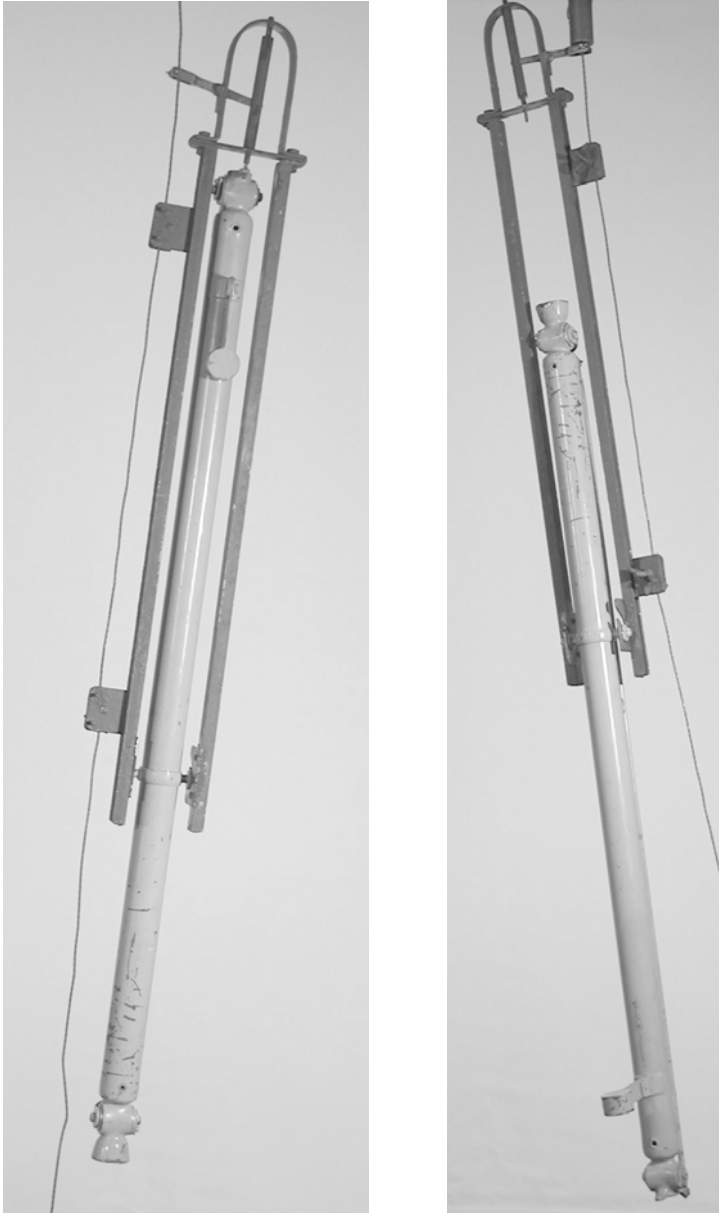
8. Richards store vannahenter. Se Richard: La bouteille Richard (petit et grand modele). Bull. De l'Inst. Ocean de Monaco, no. 373, 1920.
