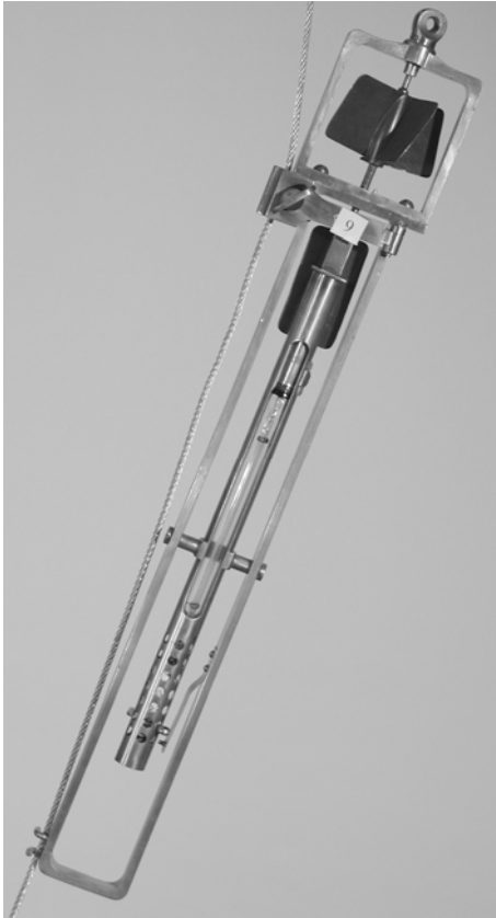
16. Venderamme for 1 termometer, med propellutløser. Se Helland-Hansen: "The Ocean Waters" 1912.
