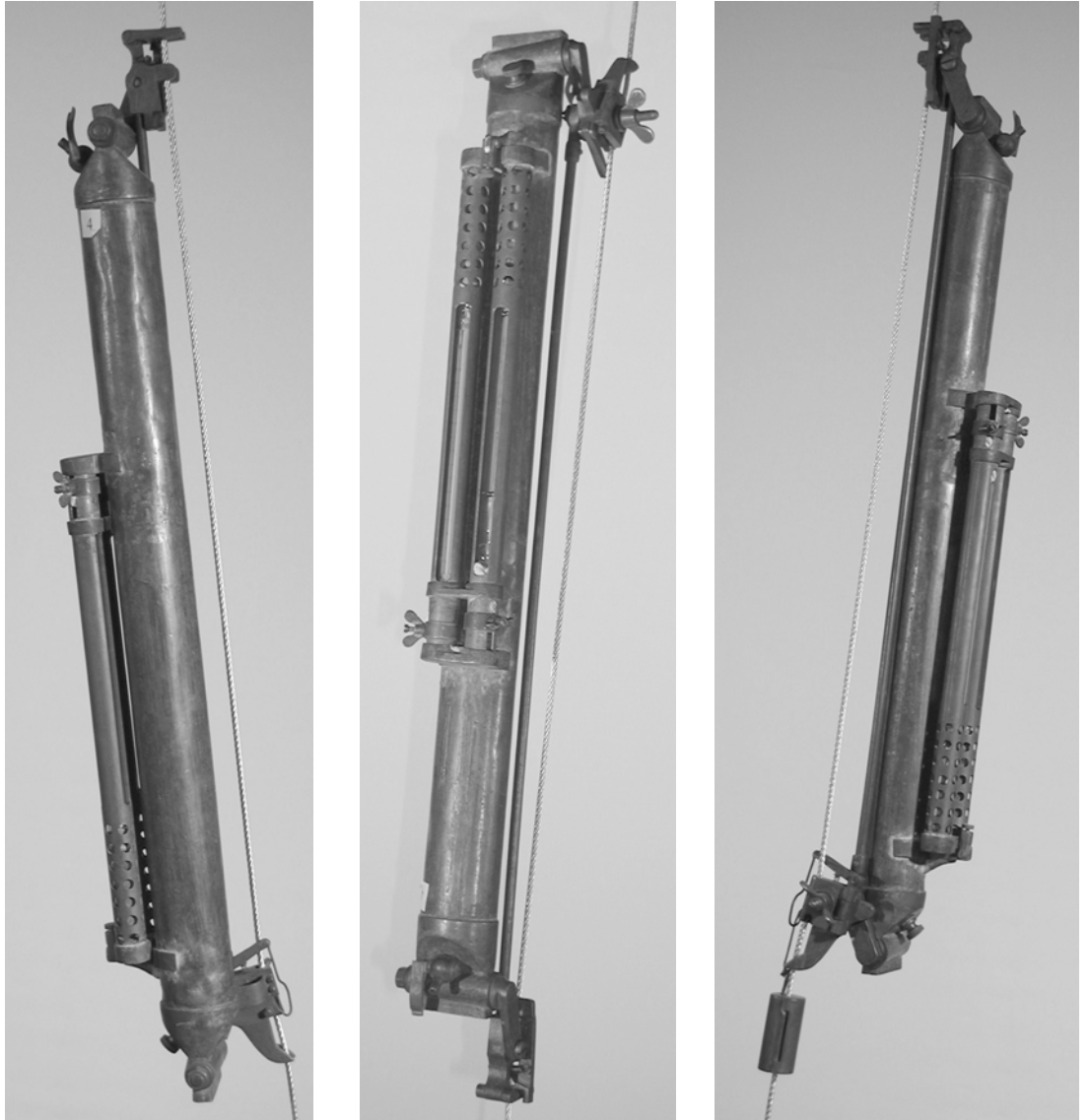
12. Nansens originale vannhenter fra 1913. Beskrivelse i Helland-Hansen og Nansen: "The Eastern North Atlantic" 1926. Instrument 4 i montereren
