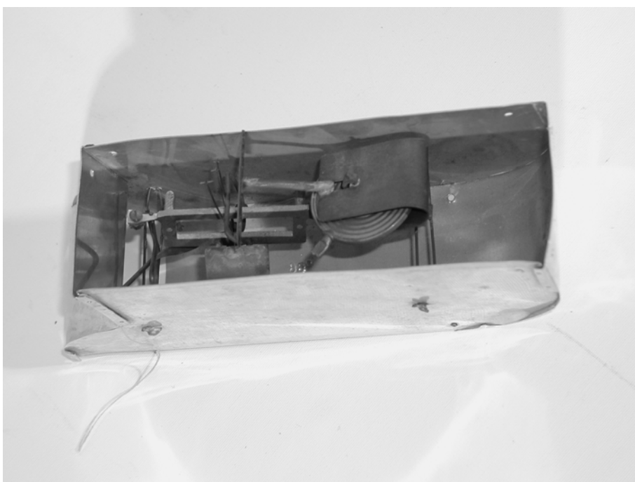
39. Meteorologisk sonde, sendes opp i ballong, skal gjenfinnes.
