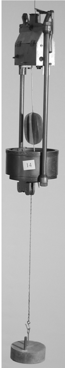
20. Nansens pendelstrømmåler, liten utgave. Se Nansen PdC nr. 34, 1908. Instrument 14 i monteringen
