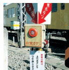
支障報知装置
