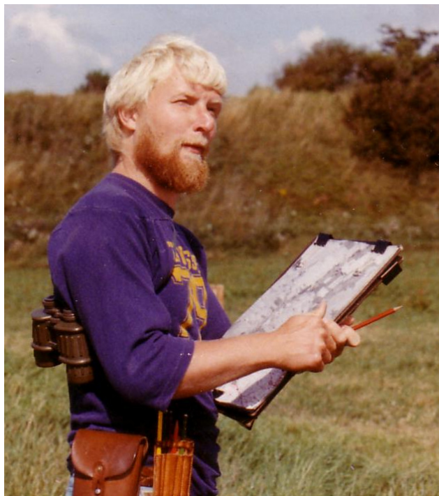
Topografassistent Poul-Erik Topshøj rekonoscerer i Sydvestjylland i 1981. Udstyret han har med er indtegningsmappe med kopi af kvarten på papir til at tegne og skrive på, blyantsetui med blyanter, passer, transversalmålestok og farveblyanter samt en kikkert til fjernobservationer.
