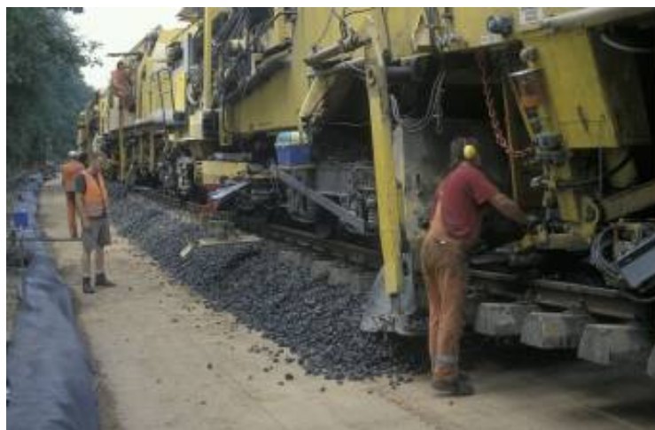
Abbildung 1 Großmaschinen bei einer Baudurchführung, Quelle DB Netz AG
