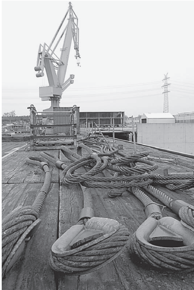
Ein 150-Tonnen-Hellingkran, mit im Vordergrund liegenden diversen (Anschlag-)Trossen
