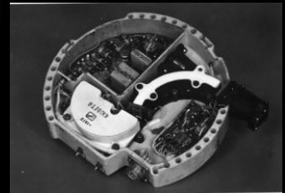
РИЭП-2801 многоканальный спектрометр заряженных частиц с КЭУ в качестве детекторов
