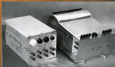
РИЭП-2801 многоканальный спектрометр заряженных частиц с КЭУ в качестве детекторов
