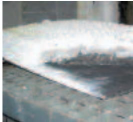
Abb. 8: Im Brandfall schäumt der Brandschutzanstrich auf das rund 50-fache seiner ursprünglichen Dicke auf und bildet eine isolierende Schicht.
