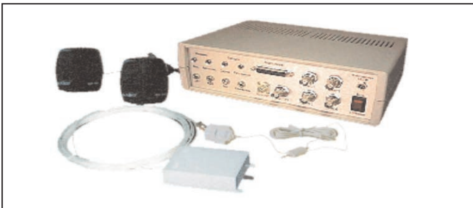
ŞƏKİL 5. "ARK-D4" MƏLUMATIN SIZMA KANALINI MÜƏYYƏN EDƏN APARAT
