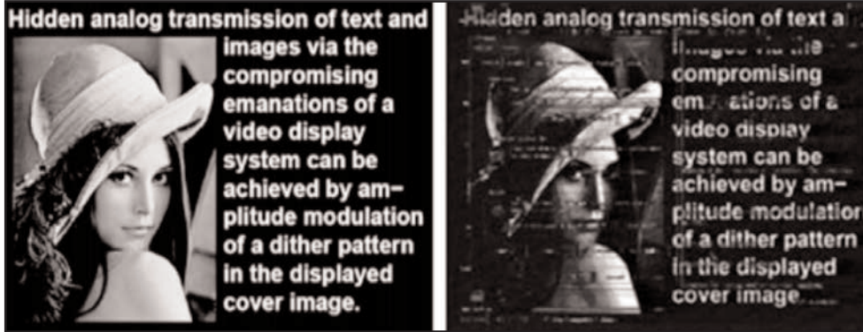
ŞƏKİL 4. a) MONİTORA ÇIXARILMIŞ ŞƏKİL, b) TEXNİKİ KƏŞFİYYAT VASİTƏSİ İLƏ ƏLDƏ OLUNMUŞ ŞƏKİL
