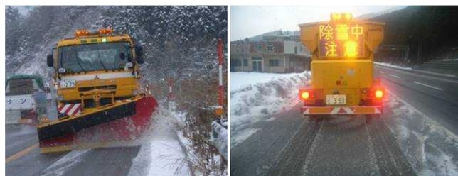
路面の積雪を排除する除雪トラック
