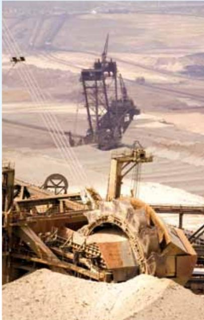
Vier bis fünf Mann sind pro Schicht zur Bedienung eines Schaufelradbaggers erforderlich: Der Dienst habende Baggerführer steuert das Großgerät von einer Kanzel in der Nähe des Schaufelrads.
