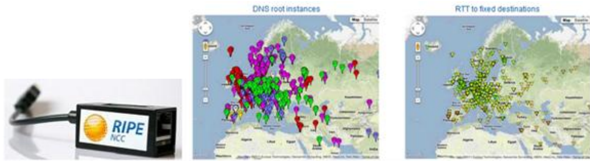
Figura 64. Sonda RIPE Atlas i exemple de mapes disponibles
