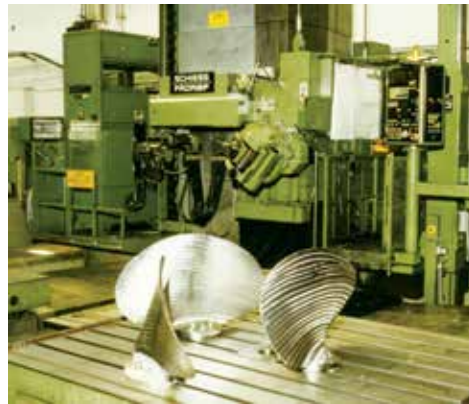
Koneistettuja vesiturbiinin siipiä.
