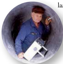
Tarkastaja Unto Loponen tekemässä ultraäänitarkastusta 1980-luvun alussa.
