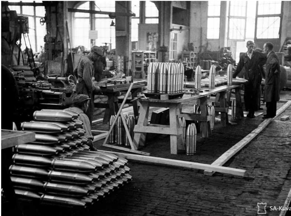
Ammusten kuoria valmisteilla Lokomon konepajalla. SA-kuva
