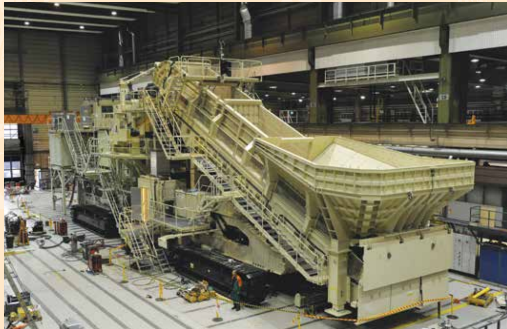
Vuonna 2013 valmistununeen Lokotrack LT200 kokoonpano käynnissä. Kokoonpano tapahtui Järvenpäässä, suunnittelu Tampereella.
