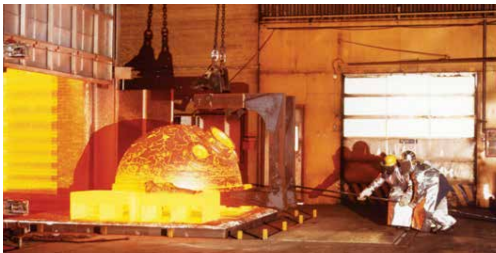
Mir-sukellusaluksen miehistöpallon lämpökäsittely käynnissä.
