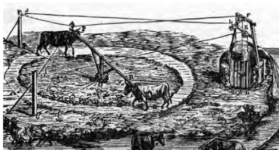
Figura 14. "Bomba de la pampa". Mecanismo de tres cuerpos de bomba ideado por E. Carenou y F. Lacroze (1875)
