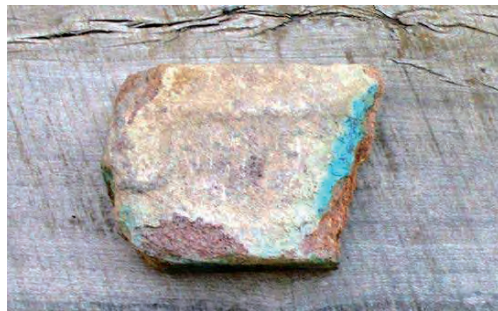
Figura 7. Ingenio Victoria. Ladrillo refractario, probablemente fabricado en Staurbridge (largo máximo, 165 mm).
