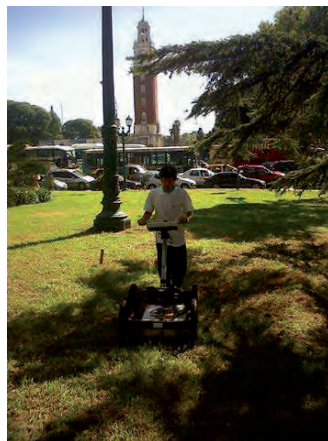
Figura 8. Barrido de la superficie de un sector de Plaza San Martín a través del uso de un georadar.
